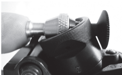
Bild 5: Farbfiltersystem Wyss, aufsteckbar
