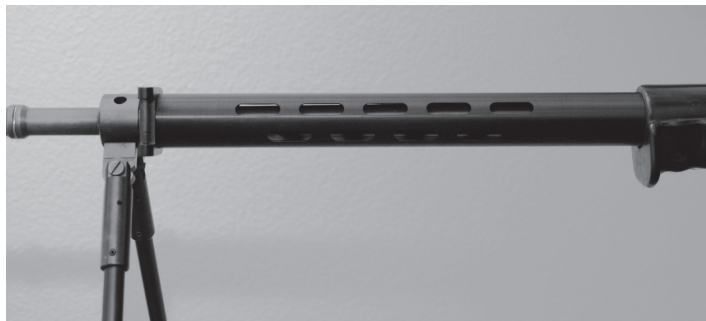
Bild 17: Mantelrohr zu Stgw 57
