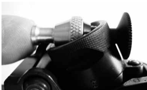
Bild 5: Farbfiltersystem Wyss, aufsteckbar
