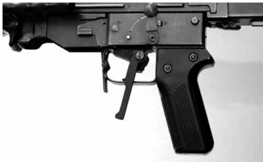
Bild 17: Winterabzug für Linksschützen zu Stgw 57
