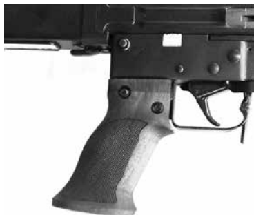
Figure 13: Poignée de pistolet Tactical pour F ass 57
