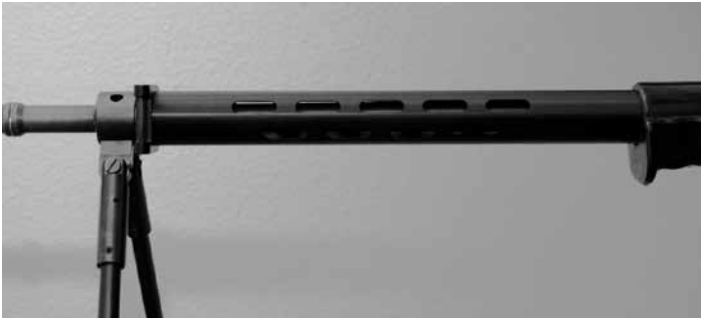
Bild 16: Mantelrohr zu Stgw 57
