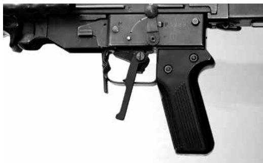
Figura 17: Grilletto ausiliario d'inverno per F ass 57
